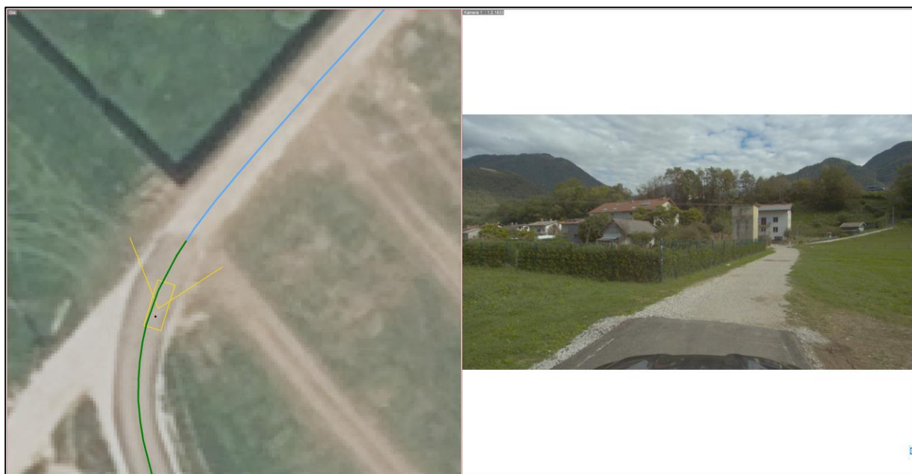
Slika 3.1: Sprememba ustroja iz asfalta v makadam
